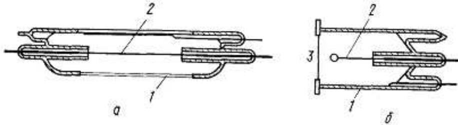
Рис. 16: Различные типы счетчиков Гейгера: а) цилиндрический; б) торцовой
