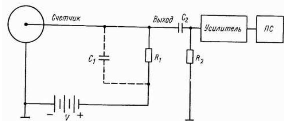
Рис. 17: Схема включения счетчика Гейгера.
