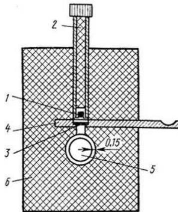
Рис. 1: Схема блока счётчика Гейгера и радиоактивного  $\beta$ -источника. 1 — радиоактивный источник, 2 — держатель радиоактивного источника, 3 — поглотители, 4 — держатели для поглотителей, 5 — счетчик Гейгера, 6 — блок свинцовой защиты.
