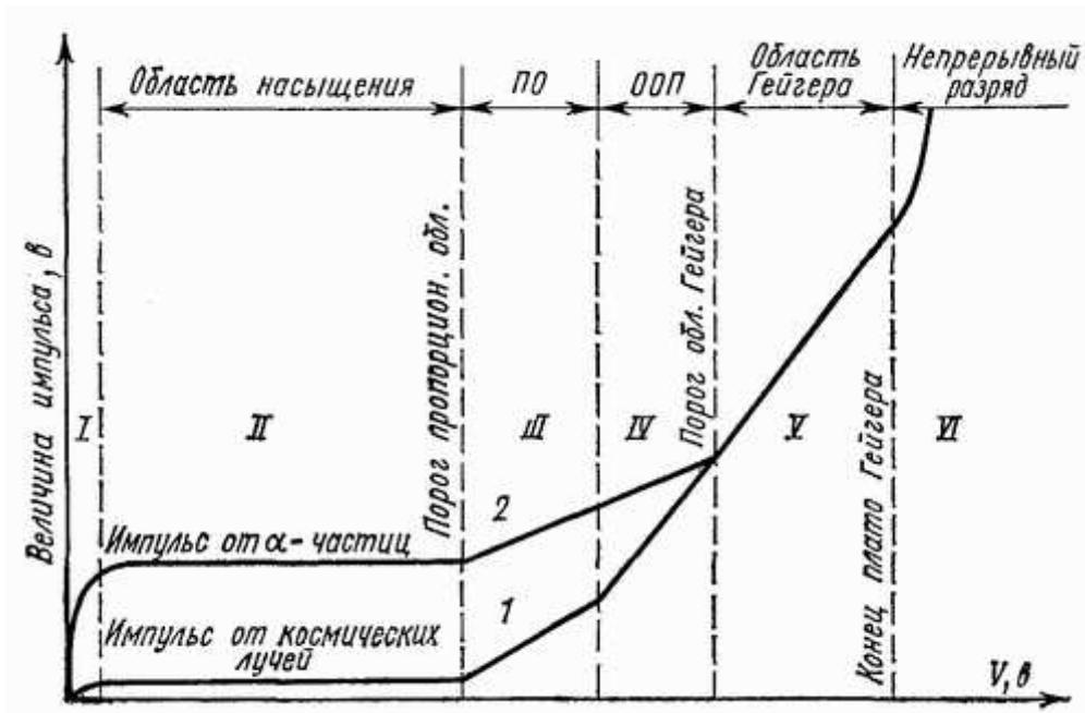
Рис. 18: Вольт-амперная характеристика счетчика в различных областях напряжений
